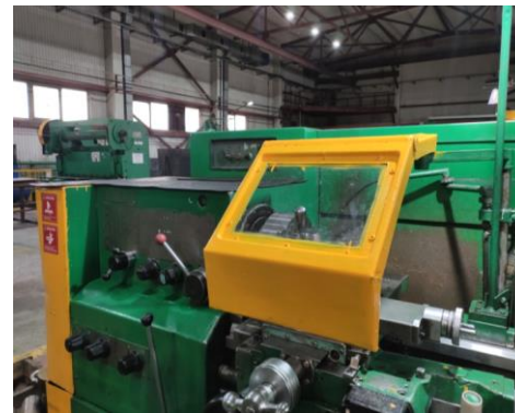
Установка защитных экранов и ограждений на вращающихся элементах оборудования
